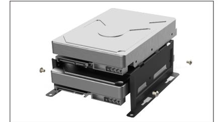
Encuentra las ubicaciones de los discos duros. Instale el HDD superior en la bandeja del HDD y luego deslícelo en la ubicación del HDD superior. El botón HDD es para asegurar con tornillos en el marco de la caja.
