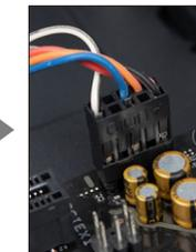
Busque el conector de la placa de circuito impreso del conector de audio y enchufe en la ranura correspondiente de la placa base. La ubicación de la ranura se encuentra en la placa base.
