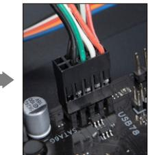
Busque el conector del USB 2.0 y conéctelo la ranura correspondiente en la placa base. Espacio ubicación, por favor busque en el manual de la placa base.
